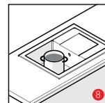
8. После нанесения силиконового герметика установите мойку по месту. Возьмите кастрюлю, наполните ее водой и поставьте в чашу мойки, так мойка плотнее прижмется к столешнице. По контуру мойки удалите излишки силиконового герметика и оставьте на 30 минут. После этого установите сифон и сливной клапан.
