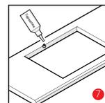
7. Уберите мойку с поверхности столешницы, возьмите силиконовый герметик и нанесите его по контуру выреза. Наносить стоит единой линией, без прерывания.
