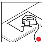
4. Сверлом сделайте сквозное отверстие внутри линии шаблона, возьмите электролобзик и произведите выпил вдоль карандашной линии.
